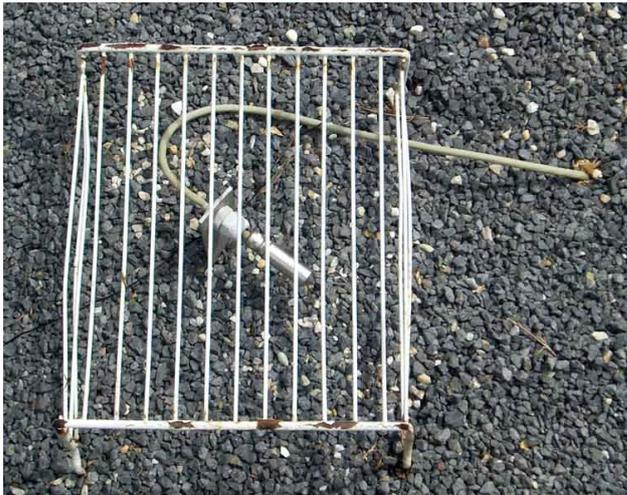
Für die Ermittlung der Bodenoberflächentemperatur wird das Pt-100 Verfahren (Widerstand) angewendet.
