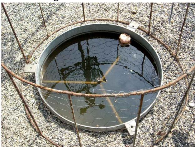
Die Verdunstung wird mit einer einfachen Verdunstungspfanne gemessen. Mit Hilfe eines Messrohres können die Werte abgelesen werden.
