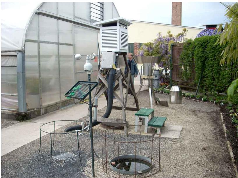
Der Boden in unmittelbarer Nähe der Messgeräte ist mit Kieselsteine belegt des Weiteren befindet sich ein asphaltierter Gehweg gleich daneben.
