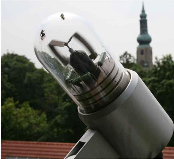
Damit wird die Sonnenscheindauer festgehalten. Beim Sonnenscheingeber Solar 111B werden lichtempfindliche Zellen von einem laufend rotierenden Bügel kurzzeitig abgedeckt, die dabei auftretenden Helligkeitsunterschiede werden ab einer bestimmten Differenz als Sonnenschein interpretiert.
