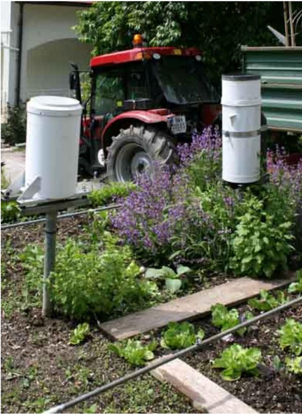
Zur Niederschlagsmessung werden wieder zwei Regentmesser verwendet. Ein Regentmesser arbeitet nach dem Wippenprinzip. Die Zahl der Wippenschläge gibt Auskunft über den gefallen Niederschlag. Sie werden elektrisch registriert und an die Zentrale geschickt. Der zweite Regentmesser nach Hellmann wird wieder zur Kontrolle benutzt.
